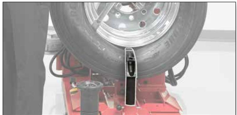
Utiliser l'accessoire de crochet standard pour monter et démonter les assemblages avec chambre à air, les pneus surdimensionnés simples et d'autres assemblage plus complexes.
