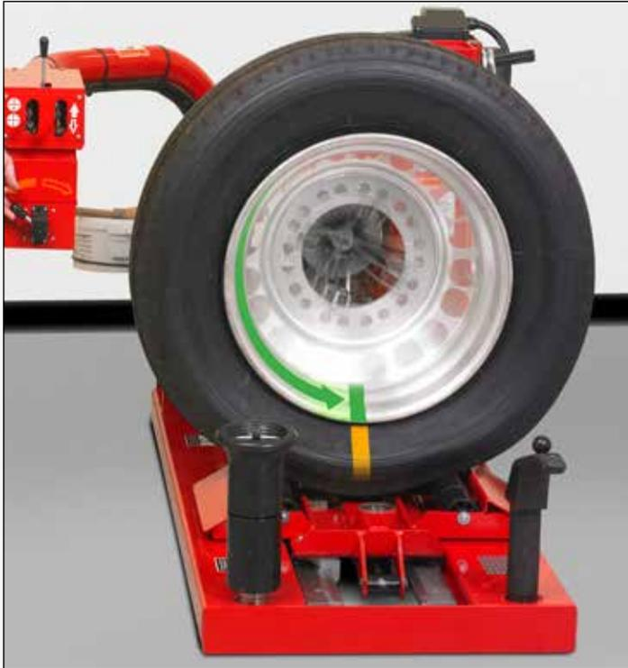
Lorsque combiné avec l'équilibreur de roue ForceMatch® (à droite), le TCX625 permet le repositionnement jante/pneu pour obtenir le meilleur confort sur la route.
