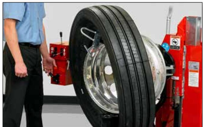
✓ Pour plusieurs pneus standard, le montage très rapide des deux talons en même temps est possible.
